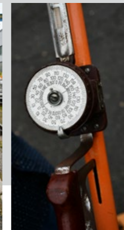
ONDŘEJ KRULÍKOVSKÝ S JEDNÍM Z JEHO OBLÍBENÝCH ARTEFAKTŮ – HISTORICKOU ROZCHODKOU NA MĚŘENÍ ROZCHODŮ A PŘEVÝŠENÍ KOLEJÍ
