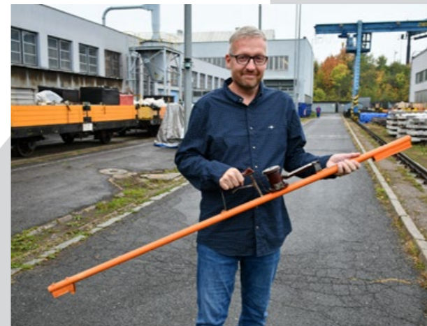
ONDŘEJ KRULÍKOVSKÝ S JEDNÍM Z JEHO OBLÍBENÝCH ARTEFAKTŮ – HISTORICKOU ROZCHODKOU NA MĚŘENÍ ROZCHODŮ A PŘEVÝŠENÍ KOLEJÍ
