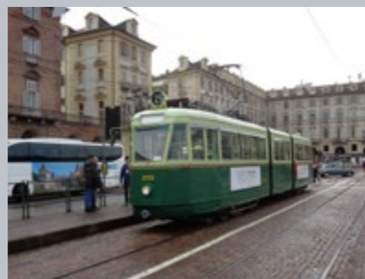
ČLÁNKOVÁ TRAMVAJ 2759 SEŠTAVENÁ V ROCE 1958 ZE DVOU DVOUNÁPRAVOVÝCH MOTOROVÝCH VOZŮ ŘADY 626–685 (PŮVODNÍ VOZY Z ROKU 1911)
