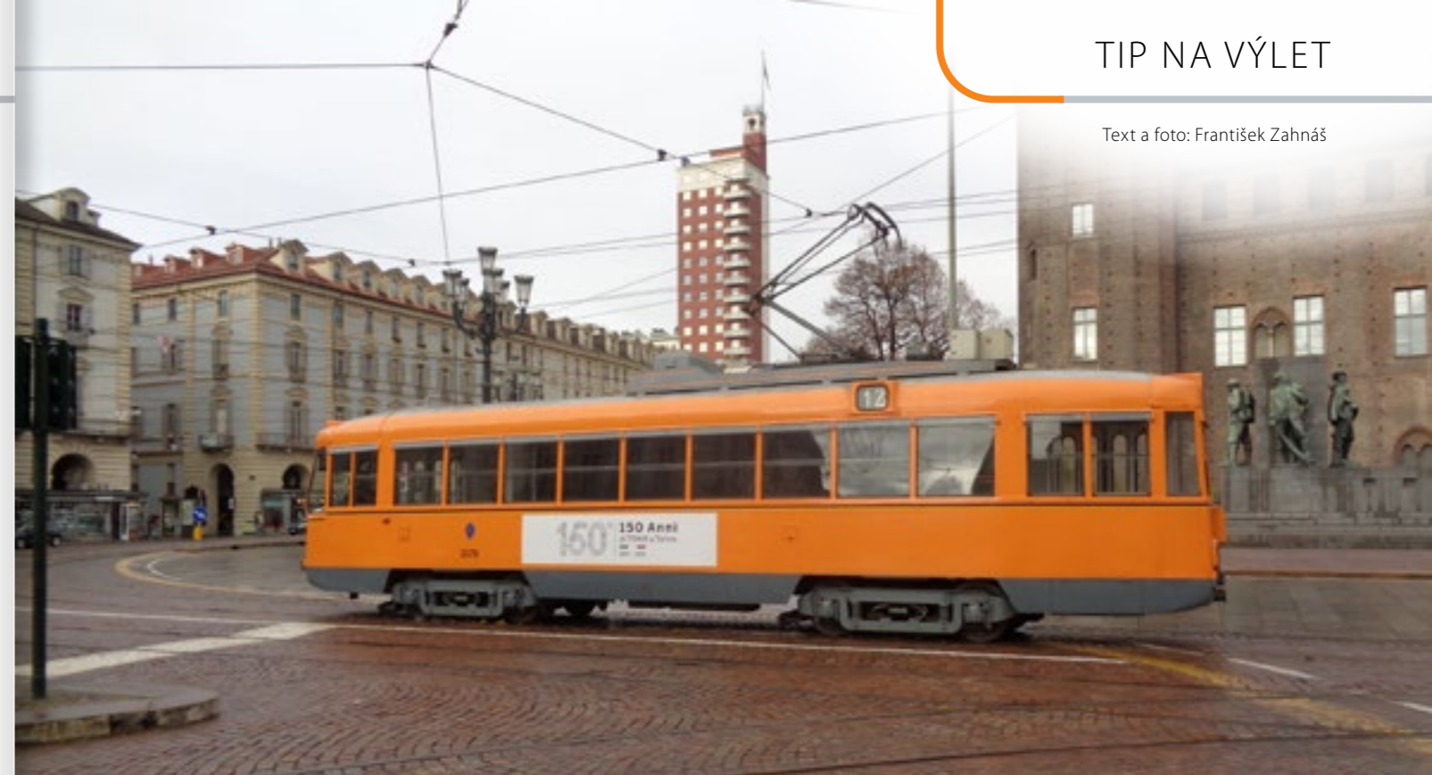
ČTYRNÁPRAVOVÝ VŮZ 3179 Z ROKU 1958 NA PIAZZA CASTELLO; VÝROBCE FIAT; V ROCE 1977 NOVÁ VOZOVÁ SKŘÍŇ, ROKU 2007 RESTAUROVÁN NA POJÍZDNÉ DIVADLO
