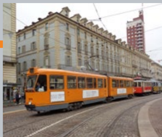
ČLÁNKOVÝ VŮZ 2847 SEŠTAVENÝ ZE DVOU VOZŮ PETER WITT ŘADY 2100, RESP. 2200 V ROCE 1959; VYFOCEN V GIARDINI REALI
