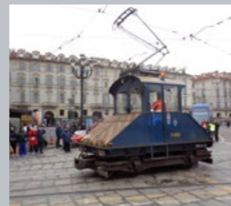
POSUNOVACÍ LOKOMOTIVA T450 VZNIKLA V ROCE 1957 PŘESTAVBOU PŮVODNÍHO MOTOROVÉHO VOZU Č. 81 Z ROKU 1902
