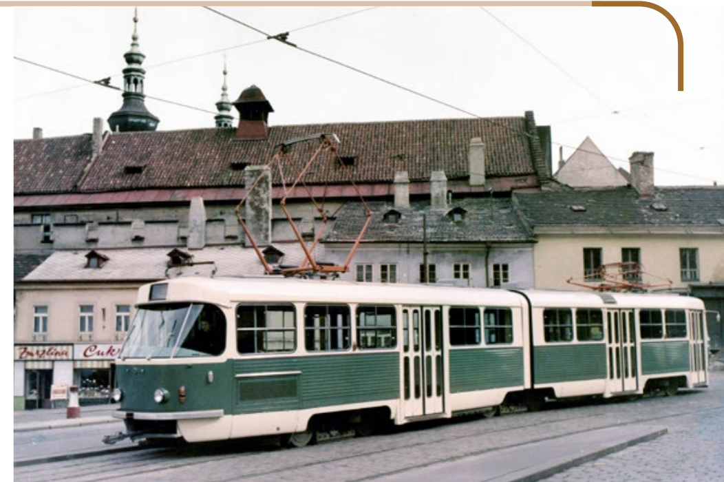
OBOUSMĚRNÁ ČLÁNKOVÁ TRAMVAJ K5AR V TROPICKÉ ÚPRAVĚ VYVINUTÁ PRO EXPORT DO EGYPTA. NA SNÍMKU PŘI ZKUŠEBNÍ JÍZDĚ V PRAZE NA POHOŘELCI V ROCE 1970 FOTO: ČKD PRAHA
