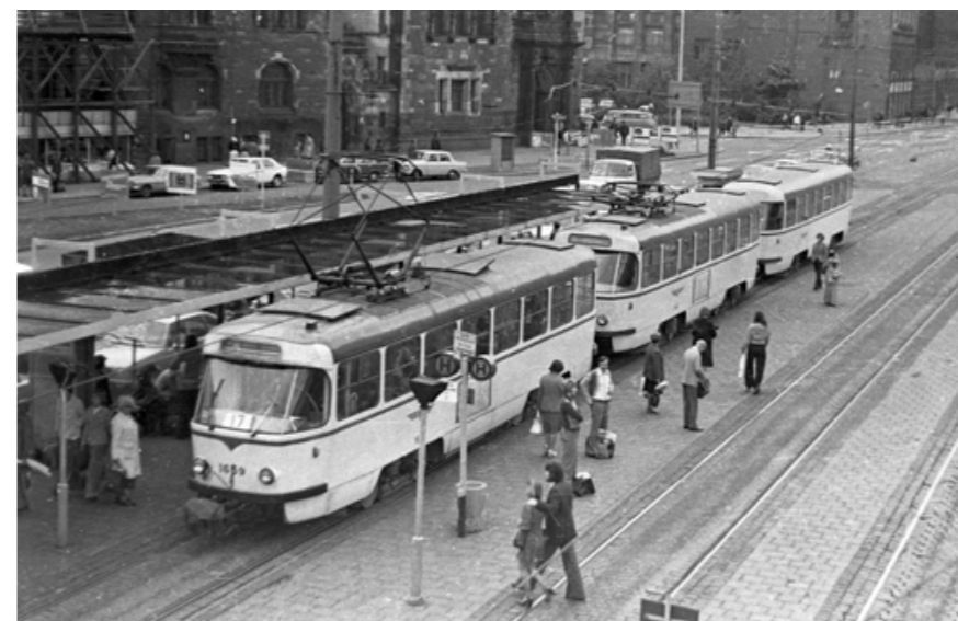
TRAMVAJE ŘAD T4/B4 A T3/B3 (V MODIFIKACÍCH PRO PROVOZ S VLEČNÝMI VOZY – ELEKTRICKÉ VÝZBROJE UB13 A UB14) BYLO MOŽNÉ PROVOZOVAT V RŮZNÝCH SESTAVÁCH VČETNĚ TŘÍVOZOVÝCH VLAKŮ T+T+B, TZV. GROSSZUGŮ. LIPSKO, KOLEM ROKU 1977 FOTO: PETR MAJZNER
