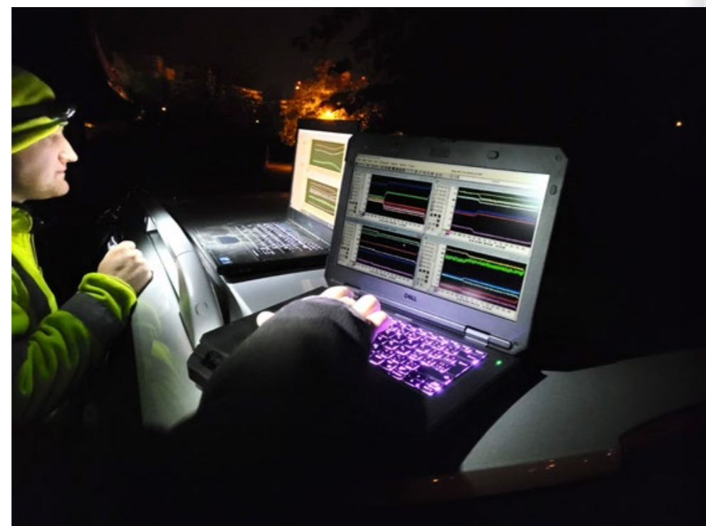
CHOVÁNÍ MOSTU BYLO MOŽNÉ DÍKY TENZOMETRICKÝM SNÍMAČŮM VIDĚT OKAMŽITĚ
