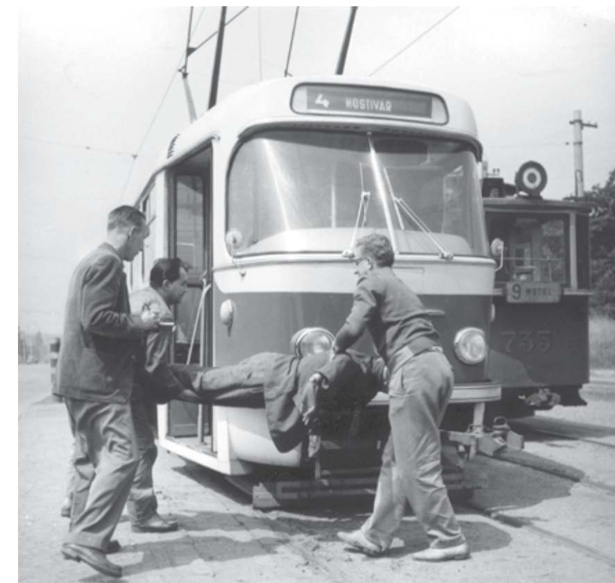
MANIPULACE S FIGURÍNOU PŘI ZKOUŠKÁCH OCHRANNÉHO RÁMU PROTOTYPU TRAMVAJE T3 Č. 6101 V ROCE 1961. ZCELA VPRAVO HLAVNÍ PROJEKTANT MECHANICKÉ ČÁSTI VOZU ING. ANTONÍN HONZÍK TOVÁRNÍ FOTO: SBÍRKA ROBERTA MARY
