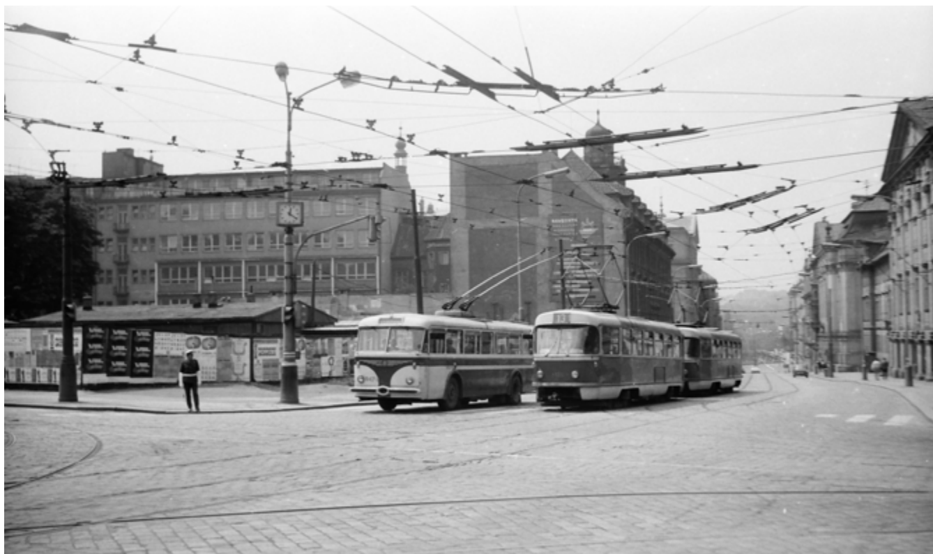
KŘIŽOVATKA KARLOVO NÁMĚSTÍ SE SLOŽITÝM TROLEJOVÝM KŘÍŽENÍM TRAMVAJE A TROLEJBUSU A TROLEJOVÝM VEDENÍM PRO SMÍŠENÝ PROVOZ TYČOVÝCH I PANTOGRAFICKÝCH SBĚRAČŮ. Z RESSLHOVY ULICE VYJÍŽDÍ TROLEJBUS ŠKODA 8TR Č. 9474 A SOUPRAVA 2XT3 Č. 6116+6117, 3. 6. 1972 FOTO: IVO MAHEL
