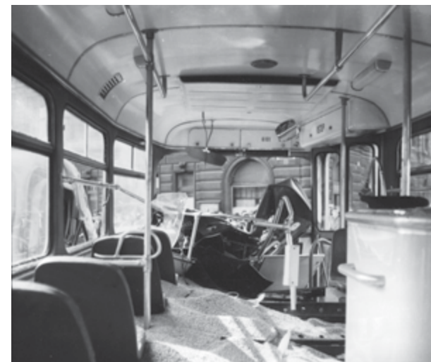
INTERIÉR PROTOTYPU T3 Č. 6101 S UMĚLOU ZÁTĚŽÍ ZASYPANOU SLADOVNICKÝM JEČMENEM, 8. 3. 1962 FOTO: PAVEL NEJEPSA
