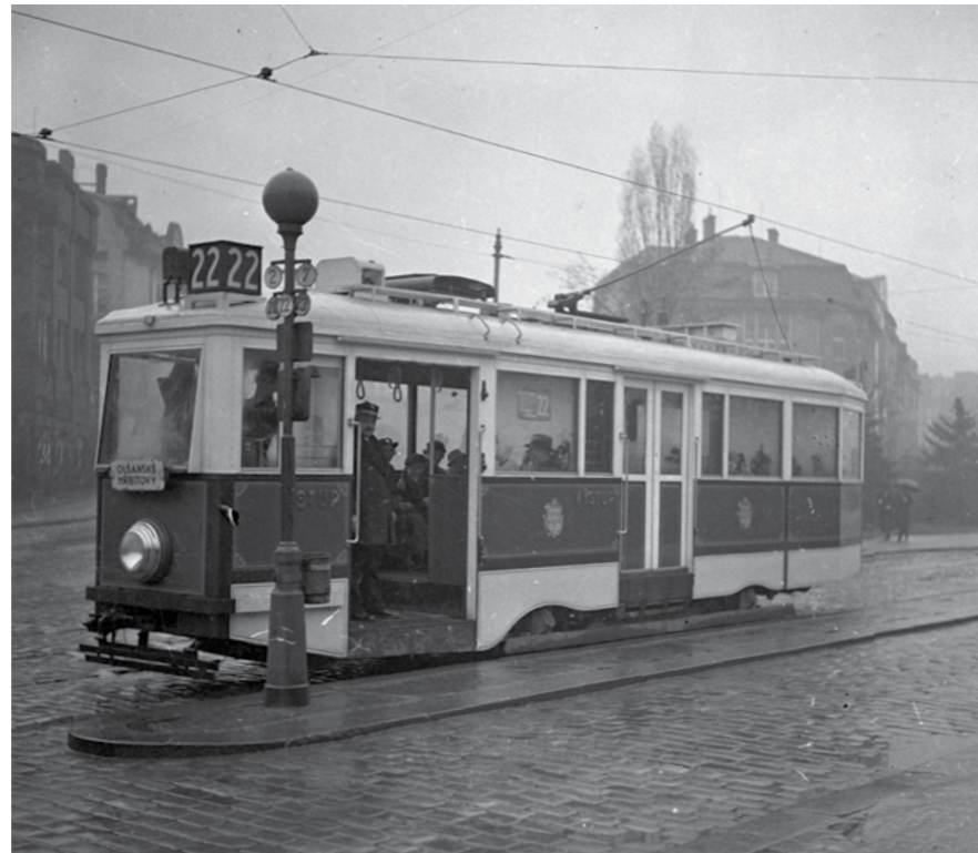
PRVNÍ TUZEMSKÉ JEDNOSMĚRNÉ TRAMVAJE TYPU „PONORKA“ (ŘADA Č. 3005–3068 EP PRAHA) ZAHÁJILY PROVOZ V LEDNU 1936 A BYLY DŮLEŽITÝM KROKEM NA CESTĚ K MODERNÍM TRAMVAJÍM. V PRVNÍCH LETECH BYLY PROVOZOVÁNY V LEVOSTRANNÉM PROVEDENÍ
