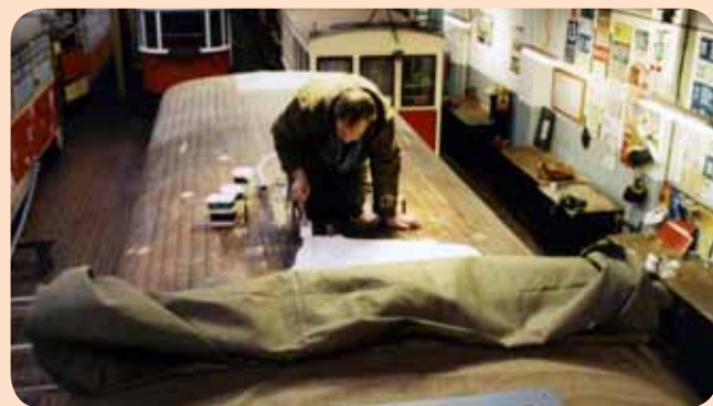
K opravě trolejbusu jsme se ve Střešovicích dostávali jen zřídkka, protože se opravovaly a rekonstruovaly především tramvaje pro jubilejní jízdy v letech 1995 a 2005. Na snímku je pokládka střešního plátna. Foto: L. Vidím
