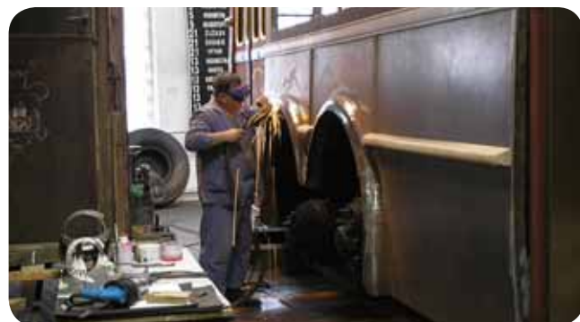
Zde plechování, montáž podběhů a blatníků. Foto: J. Wimmer
