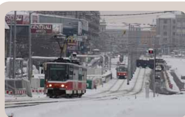
Neděle 10. ledna 2010 v poledne. Výhybky na Špejcharu fungují bez komplikací. Velmi pomáhá, že jsou zatím v otevřeném kolejové svršku...
