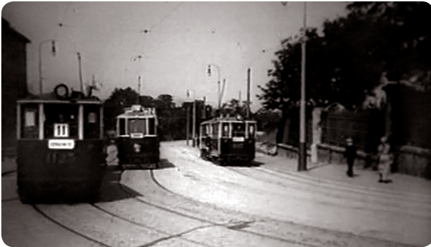
Krásný filmový záběr z dlouhé reportáže o dopravě během sokolského sletu v roce 1932 zachytil i provoz na tříkolejném úseku mezi Hládkovem a Dlabachovem. Tramvaj vpravo jede přes Hládkov do centra, tramvaj linky č. 11 (vlevo) jede ke střešovické vozovně a uprostřed jede z centra vlak na smyčku Malovanka.
