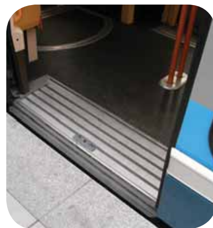
Nástupní hrana strižená na míru vysoce unifikovanému vozovému parku – typický snímek nově vzniklých tramvajových provozů (zde ve francouzském Grenoblu).
