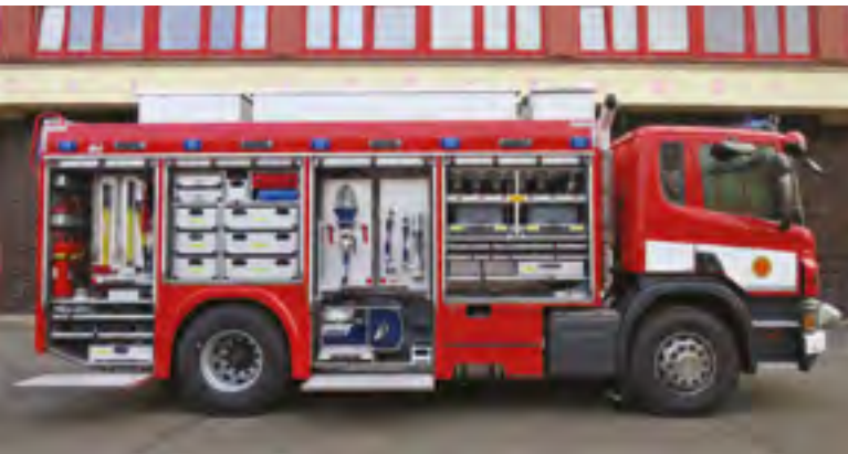
NA PRAVOBKU TECHNICKÉHO AUTOMOBILU JE ULOŽENA VÝZBROJ PRO DOPRAVNÍ NEHODY, NA LEVOBKU JE VÝBAVA PRO ŽIVELNÍ POHROMY A ELEKTRICKÉ PŘÍSLUŠENSTVÍ
