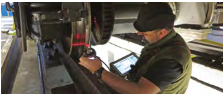
MĚŘENÍ VÝVOJE OPOTŘEBENÍ JÍZDNÍHO OBRYSU KOL SOUPRAV 4199-4300. PROVÁDÍ SE V RÁMCI REVIZE N1 NA VŠECH KOLECH SOUPRAV – U VYBRANÝCH KOL 3X PO 120 STUPNÍCH PO OBVODU KOLA
