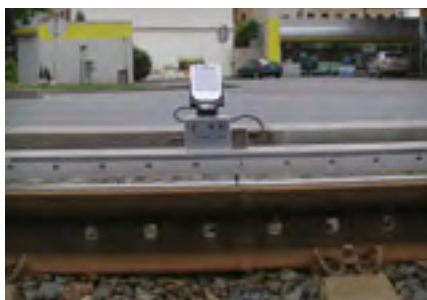
K MĚŘENÍ ROVINATOSTI SVARŮ SE POUŽÍVÁ ELEKTRONICKÁ LAŤ
