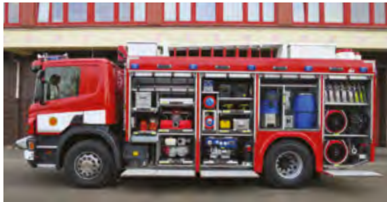
NA PRAVOBKU TECHNICKÉHO AUTOMOBILU JE ULOŽENA VÝZBROJ PRO DOPRAVNÍ NEHODY, NA LEVOBKU JE VÝBAVA PRO ŽIVELNÍ POHROMY A ELEKTRICKÉ PŘÍSLUŠENSTVÍ
