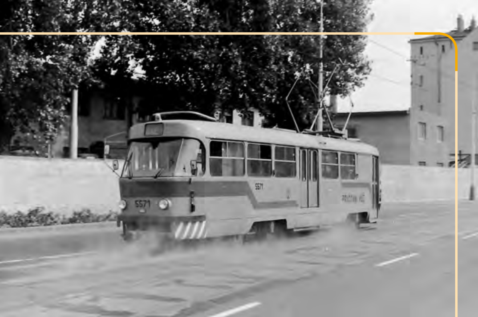
BROUSÍCÍ TĚ-TROJKA EV. Č. 5571 PŘI PRÁCI U SMÍCHOVSKÉHO NÁDRAŽÍ (SRPEN 1988)
