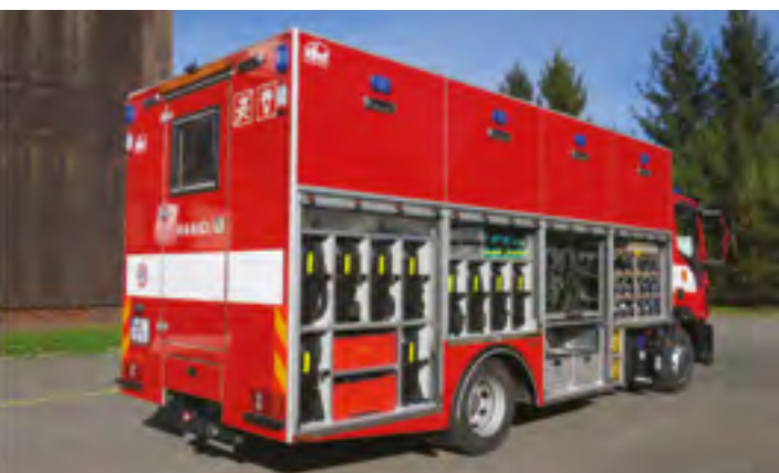
NA PRAVOBOKU „PROTIPLYNU“ JE ULOŽENA DÝCHACÍ TECHNIKA
